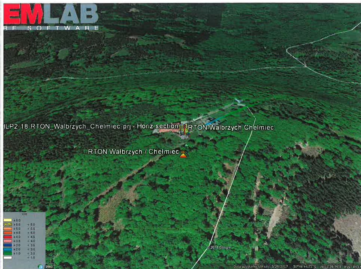
Rys. 2. Rzut poziomy rozkładu pola elektromagnetycznego anteny nowo projektowanej linii radiowej w otoczeniu RTON Wałbrzych/Chelmiec przewidzianej do zainstalowania na wysokości 57m nad poziomem terenu.
